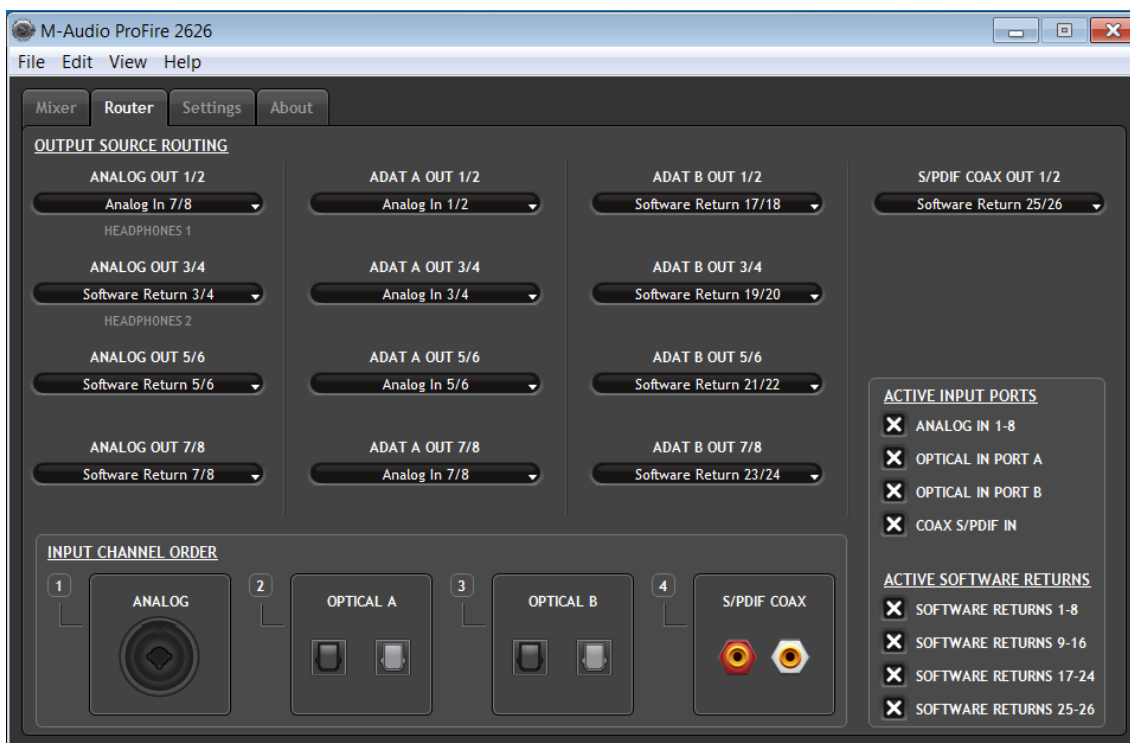
Obr. A.5: Nastavení směrování vstupů A/D převodníku do kanálů ADATu
