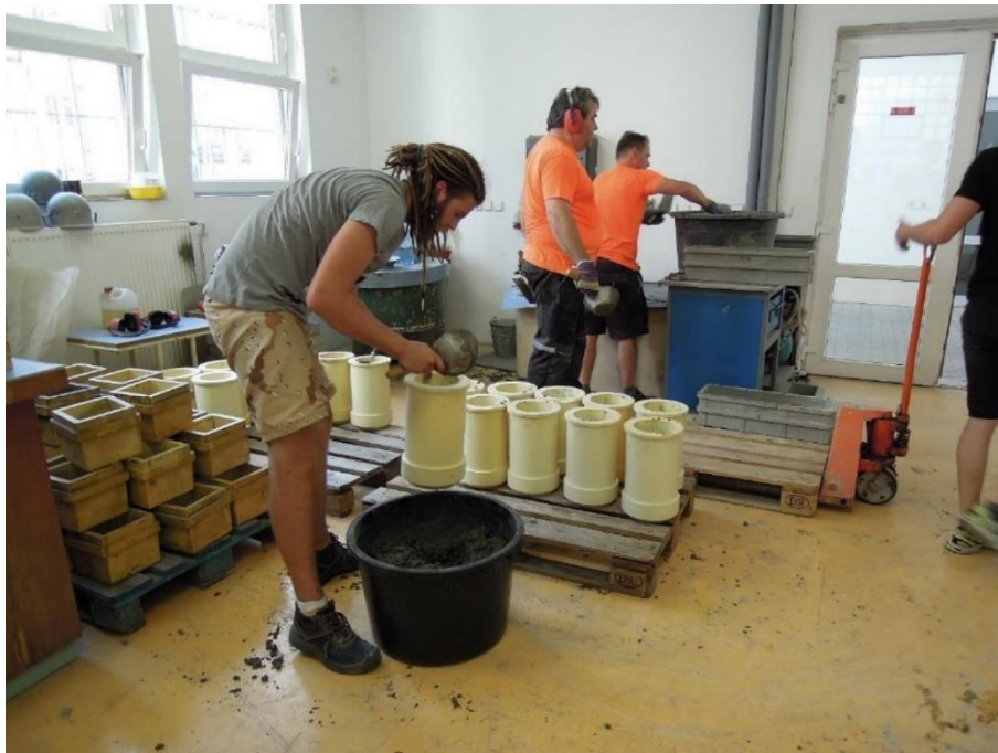
Obr. 16 Ukládání čerstvého betonu do forem
