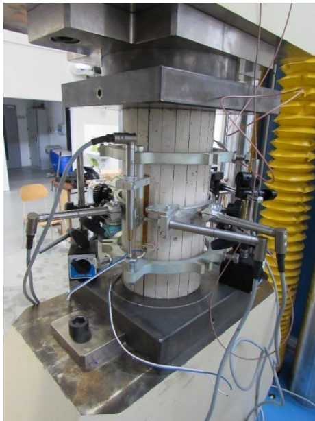
Obr. 22 Zkušební sestava pro měření deformací zkušebních válců OB1 během cyklování
