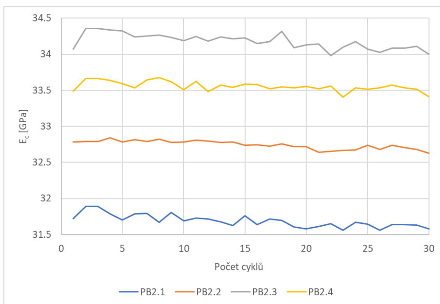
Obr. 77 Statický modul pružnosti v tlaku PB2, zatěžovací hladina 1/3 očekávané f_c
