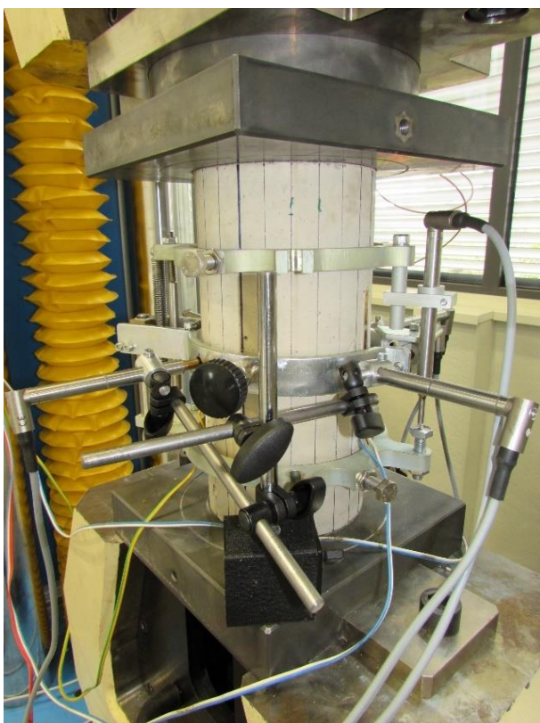
Obr. 134 Zkušební sestava pro měření deformací zkušebních válců OB1 během cyklování
