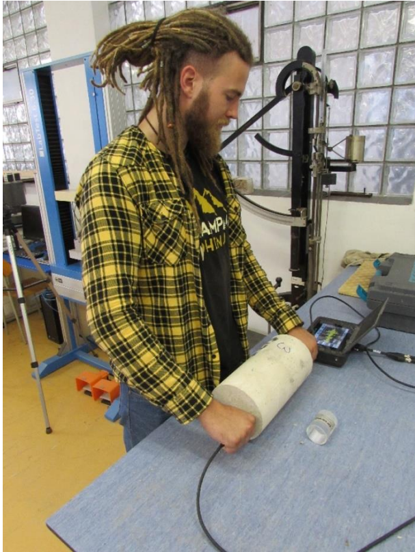
Obr. 130 Stanovení rychlosti šíření ultrazvukového vlnění pomocí ultrazvukové metody LB2
