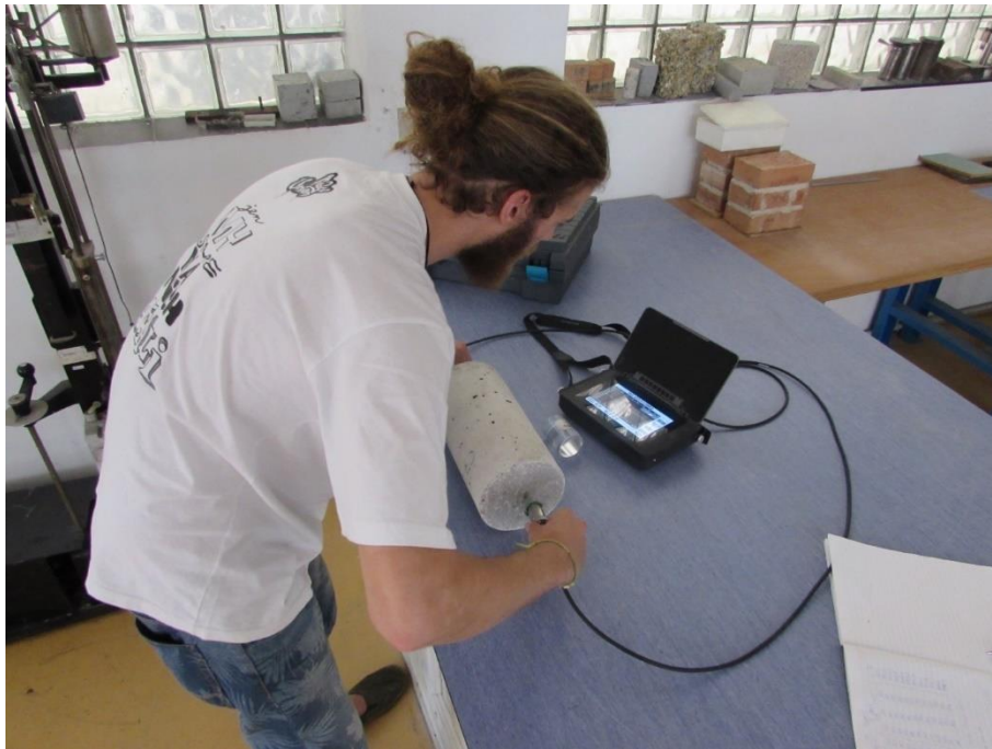
Obr. 28 Stanovení rychlosti šíření ultrazvukového vlnění pomocí ultrazvukové metody
