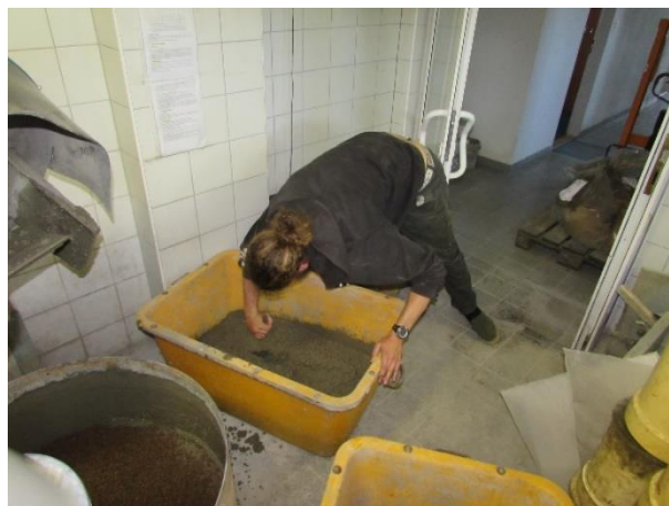
Obr. 118 Míchání čerstvého betonu LB1
