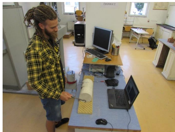
Obr. 129 Stanovení prvních vlastních frekvencí zkušební tělesa pomocí rezonanční metody LB2
