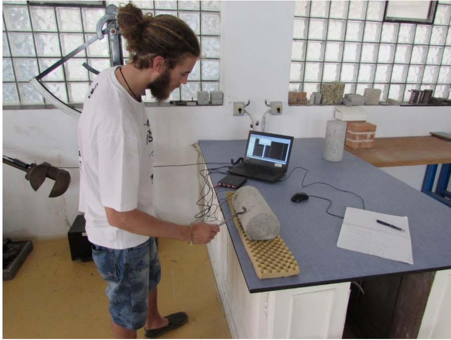
Obr. 29 Stanovení prvních vlastních frekvencí zkušební tělesa pomocí rezonanční metody
