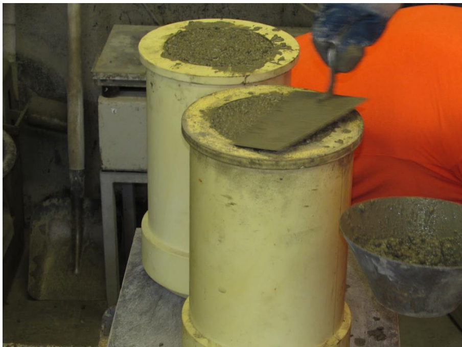
Obr. 14 Ukládání čerstvého betonu do forem
