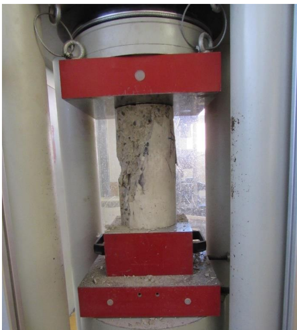
Obr. 133 Zkušební těleso porušené tlakem PB1
