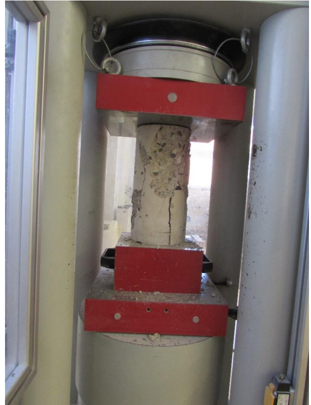
Obr. 131 Zkušební těleso porušené tlakem OB1
