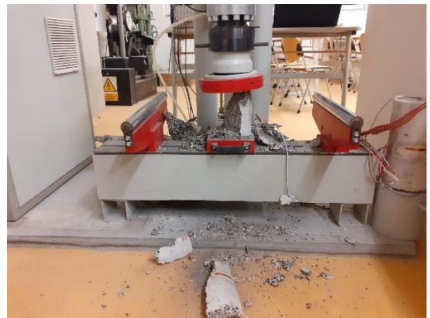
Obr. 132 Zkušební těleso LB2.12 porušené během cyklování
