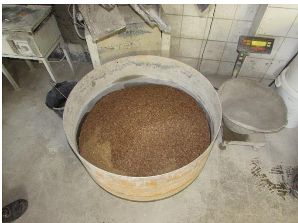
Obr. 124 Navážka předvlhčeného lehkého kameniva a písku LB2
