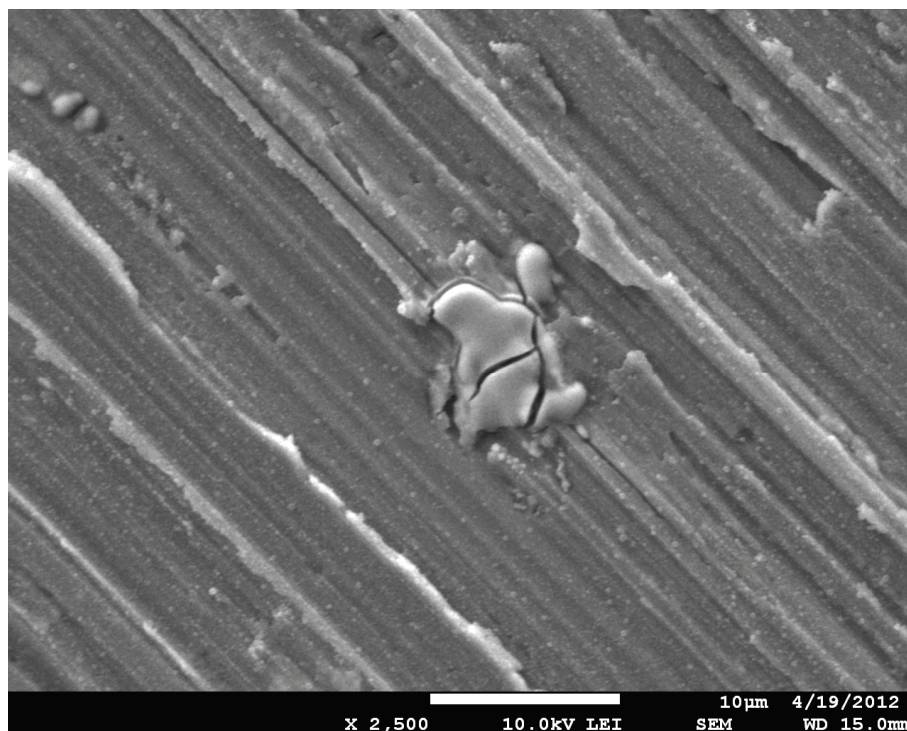
Obrázek 11: Sloučeniny ceru vyloučené na intermetaliku po ponoru při 75 °C po dobu 30 minut (SEM)
