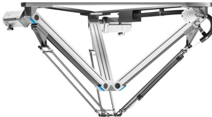
Obr. 8) Paralelní robot Tripod EXPT společnosti Festo [15]
