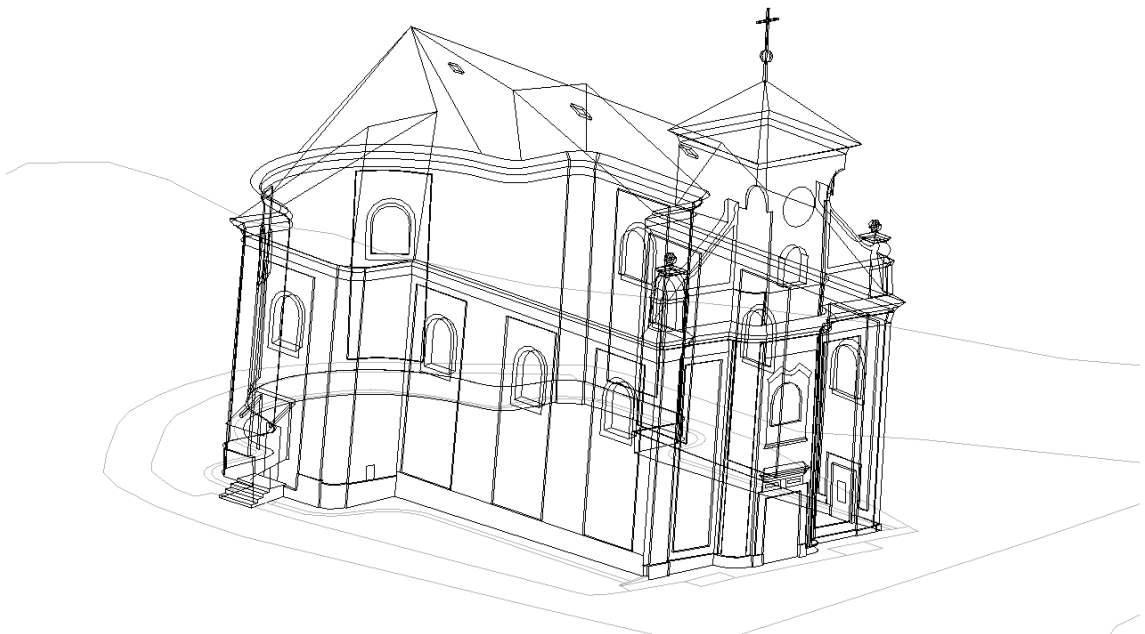
Obr. 8. 1 - Ukázka drátového modelu vytvořeného v programu MicroStation
