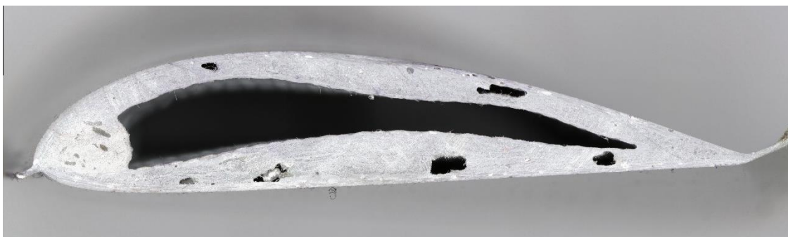
Obrázek 9. Bubliny ve struktuře listu vyrobeného ze skleněných vláken bez využití pěnového jádra.
