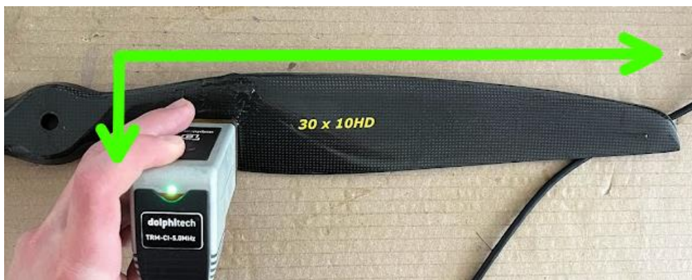
Obrázek 34. Doporučené směry postupu při testování ultrazvukem.
