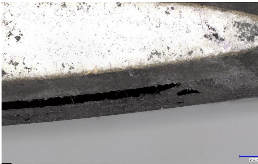
Obrázek 8. Značná delaminace vrstev u listu vyrobeného z uhlíkových vláken.
