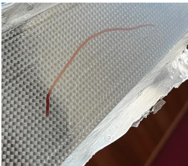
Obrázek 39. Vada povrchové vrstvy vrtule obloukového tvaru pod vyznačenou čarou o délce 78 mm. Na náběžné i odtokové hraně jsou otřepy z výroby vrtule.
