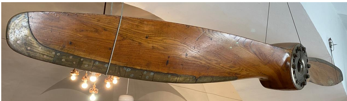
Obrázek 3. Dvoulistá dřevěná vrtule používaná na letadle BH25 s konstantním úhlem nastavení a mosaznou ochranou náběžné hrany. Vystavena ve Vrbasově muzeu ve Ždánicích.
