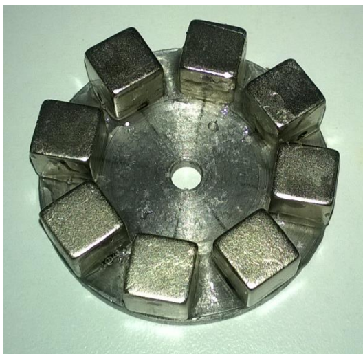
Obr. 5.3 Hotový rotorový disk
