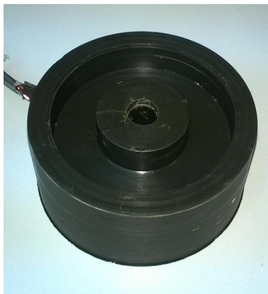
Obr. 5.2 Hotové statorové vinutí zalité v epoxidu
