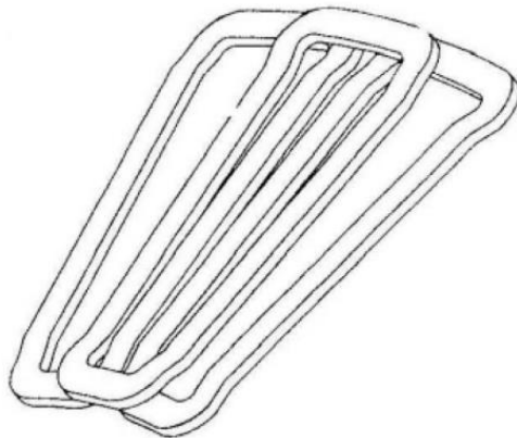
Obr. 1.14 Klasické vinutí s překrývajícími se cívkami [1].
