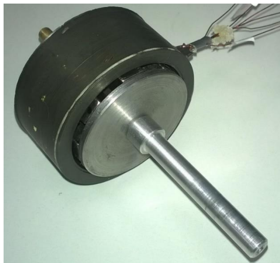
Obr. 5.4 Hotová sestava motoru
